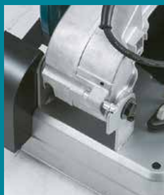
Cambio del dispositivo de bloqueo de la cabeza de la sierra.
